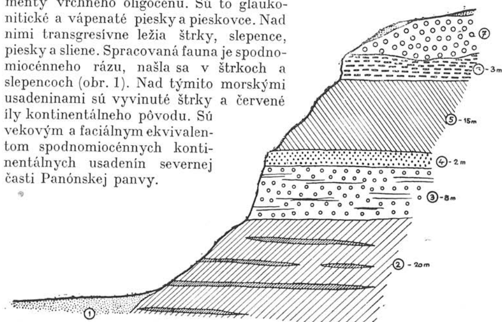
Obr. 1. Profil jarkom juhovýchodne od pustatiny Demečér na západnom svahu kopca kóty 320. 1. hlina a sutina (alúvium), 2. sivý a žltý vápenatý piesok s lavicami pieskovcov (vrchný šat), 3. štrky, piesky, lumachely a lavice slepencov so žraločimi zubami a mäkkýšmi, 4. pieskovec, 5. ílovité piesky a piesčité íly s neurčiteľnou faunou, 6. veľmi tvrdý kremitý pieskovec s mäkkýšmi, 3—6 akvitán, 7. kremité štrky a červené íly (vrchný akvitán — spodný burdigal).
